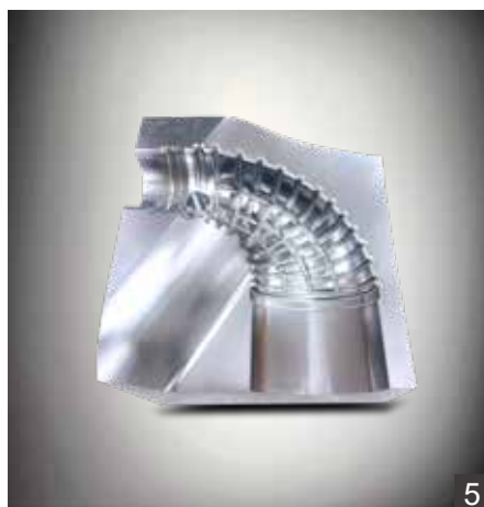
| 1. 重機骨架 2. 機車連接架 3. 機車連接架 4. 車燈模具 5. 彎管模 6. 離合器模 |
